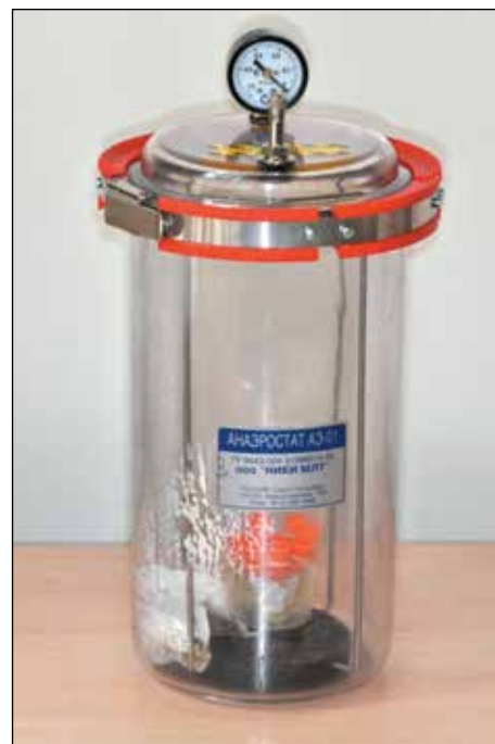
Рис. 3. Анаэробизация в компактном переносном анаэростате АЭ-01. Образцы микробиологического материала готовы к транспортировке в лабораторию
